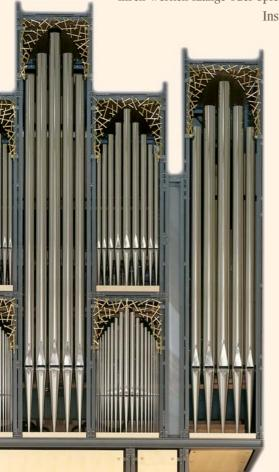
Außerdem stellte er die Pfeifen eines Manuals auf mehrere Windladen, die unabhängig voneinander durch Sperrventile zu- oder abgeschaltet werden konnten, was dem Wunsch nach schnellem Registerwechsel der Spieler entgegenkam. Der Klang aller Stimmen hatte das große Sinfonieorchester zum Vorbild.
